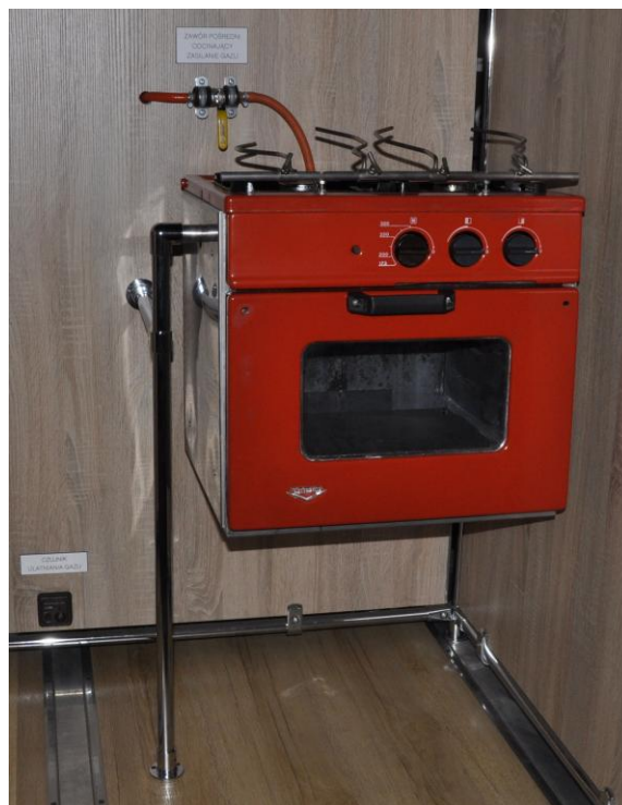
Fot.1. Kambuz. Widok ogólny jachtowej kuchenki gazowej, zasilanej z butli gazowej, dwupalnikowej z piekarnikiem. Medium propan – butan,
